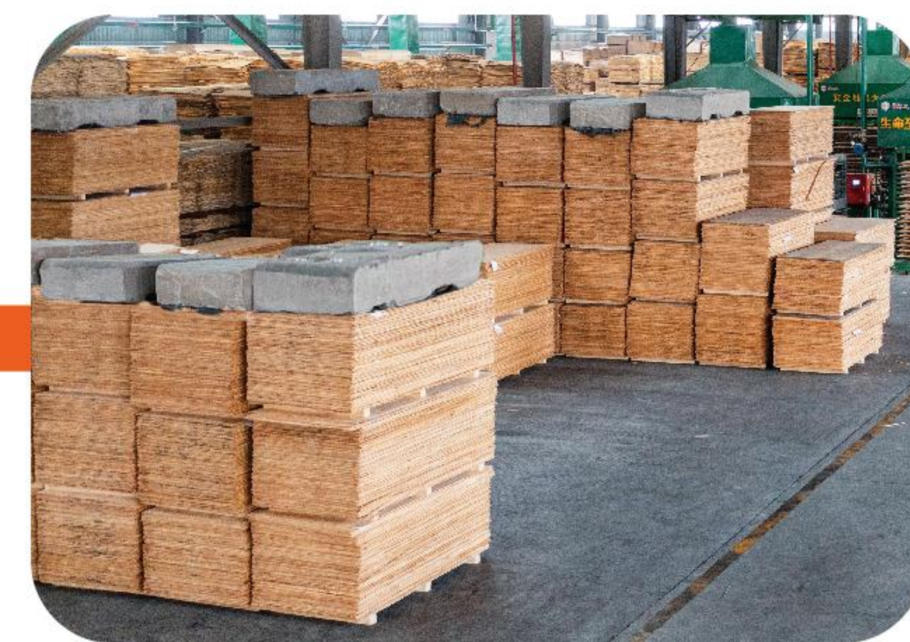
养生工序 Cooling
